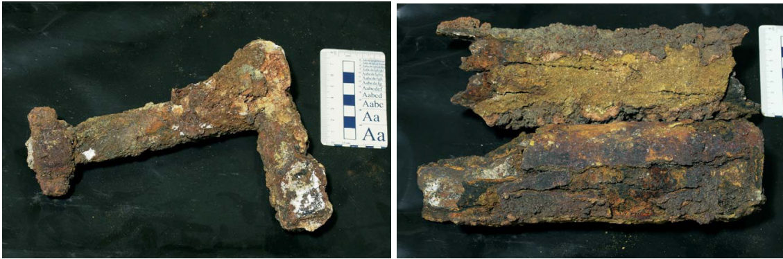
Abb. 16.1 Unvollständig (links, ein Ventil) und vollständig (rechts, ein Rohr) korrodierte Proben aus ehemaligen Salzabbaukammern des Salzbergwerkes Wieliczka /MAL 10/
