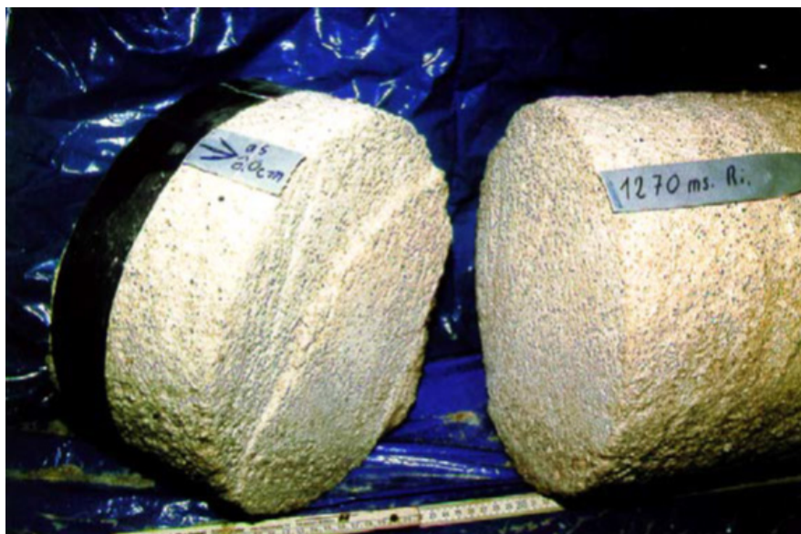
Abb. 10.3 Endstücke eines Bohrkerns aus einer Bohrung in den Altversatz von der 1260/1275 m-Sohle des Salzbergwerks Riedel /BRA 08/
