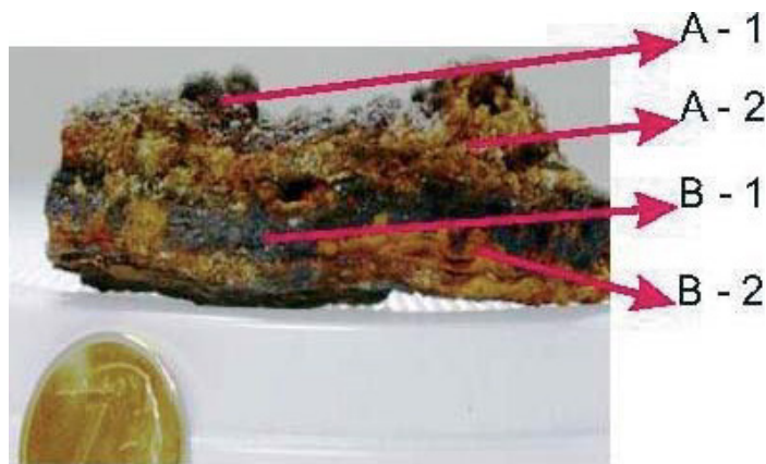
Abb. 16.2 Korrosionsschichten entlang eines Querschnittes durch ein vollständig korrodiertes Rohr aus ehemaligen Salzabbaukammern des Salzbergwerkes Wieliczka /MAL 10/
