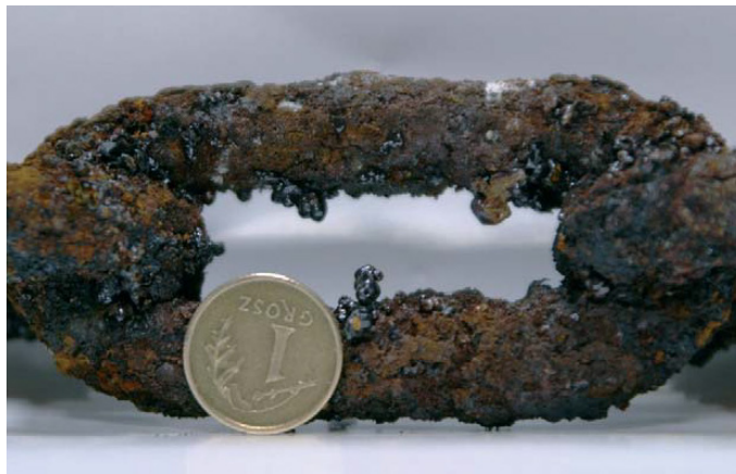
Abb. 16.3 Bläschenförmige Aggregate an einem Kettenglied aus ehemaligen Salzabbaukammern des Salzbergwerkes Wieliczka /MAL 10/
