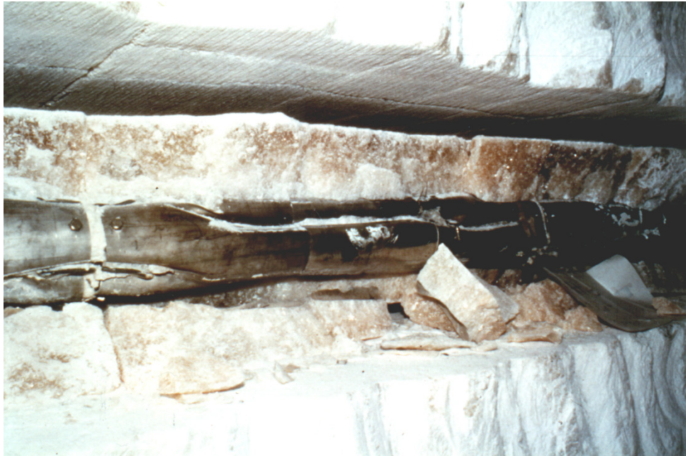
Abb. 12.1 Nach Versuchsende freigelegter Erhitzer aus dem Erhitzerversuch /ROT 86/
